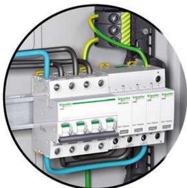
Limitatore di sovratensione iPRD 3P+N + iC60N 4P per sistema TT o TN-S (arrivo dall'alto senza pettine di collegamento)
