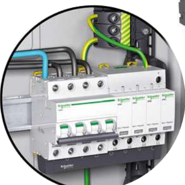
Limitatore di sovratensione iPRD 4P + iC60N 4P per sistema TN-C, TN-S o IT 230 V (L-L) con neutro, (arrivo dall'alto con pettine di collegamento)
