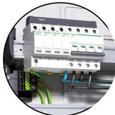
Limitatore di sovratensione iPRD 4P+ iC60N 4P per sistema TT o TN-S (arrivo dal basso con pettine di collegamento)
